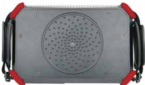
Rysunek 8 Kamera akustyczna CRY SOUND – matryca mikrofonów MEMS
