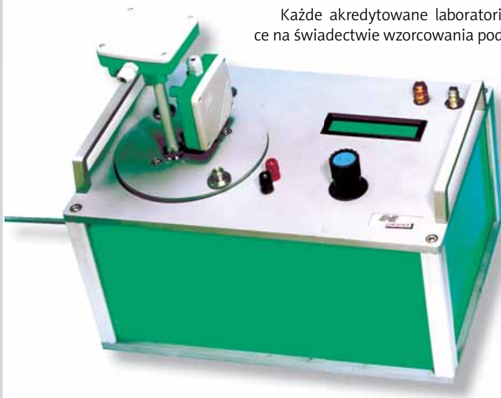
Rysunek 3 Generator wilgotności HUMOR 10
