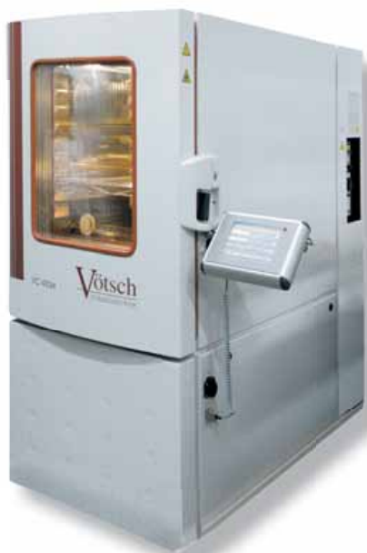
Rysunek 1 Komora klimatyczna Vötsch
